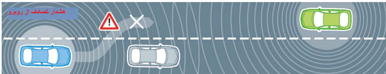
شکل ۱- آگاهی از وجود خودرو در جهت مخالف به هنگام سبقت مجاز
