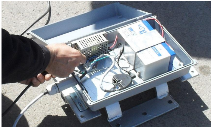
تصویر ۵ - ترکیب بندی اجزاء منبع تغذیه RSU در محل هایی که امکان استفاده از برق شبانه وجود دارد.
